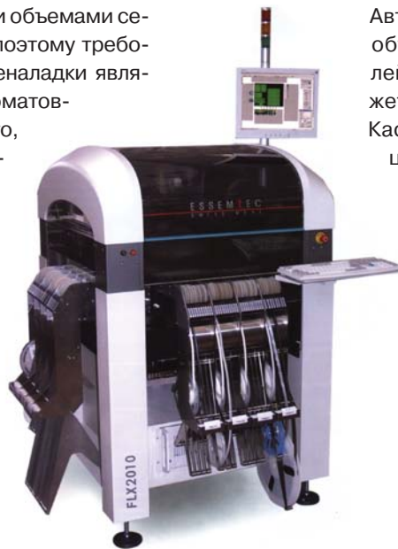
Рис. 1. Автомат для установки компонентов FLX2010
