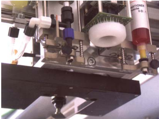
Рис. 3. Дозатор для нанесения паяльной пасты или клея
