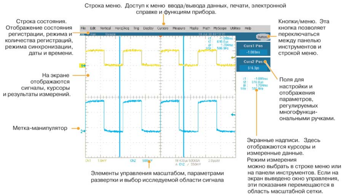
Рис. 2. Интерфейс пользователя осциллографов серии TDS5000
